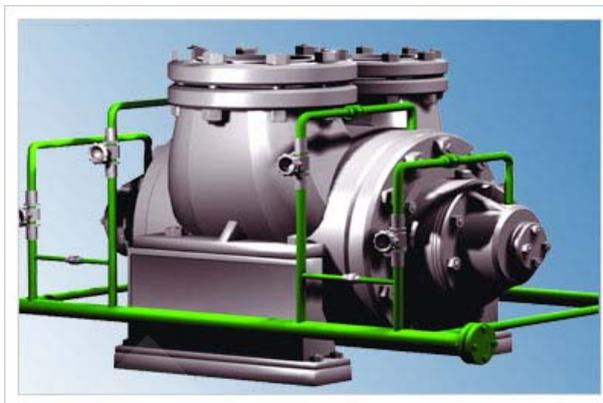
该系列泵为模块化设计，不同规格泵组件（如轴、泵盖、机械密封、轴承等）具有充分的互换性，便于后期维护。
